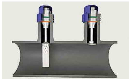
شمایی از کوپن های شناسایی جهت بررسی رفتار خوردگی خطوط لوله فولادی
